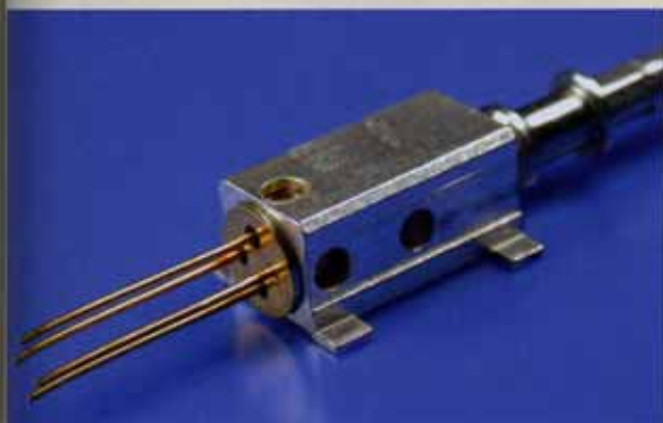
Bild 2. Klebung einer VCSEL-Diode in ein SMD-Gehäuse
