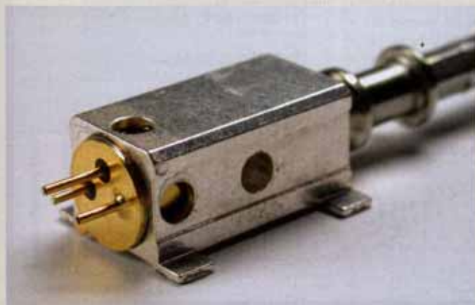
Bild 6. Modellklebung zur Analyse der Positionsstabilität
